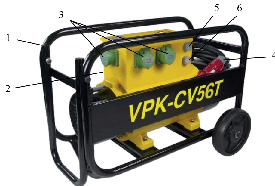
Рис. 1. Схема устройства преобразователя частоты VPK CV-56T: 1 – рама (каркас), 2 – преобразователь в корпусе, 3 – розетки для подключения вибраторов (нагрузки), 4 – кабель с вилкой для подключения к сети, 5 – кнопка включения, 6 – кнопка выключения
