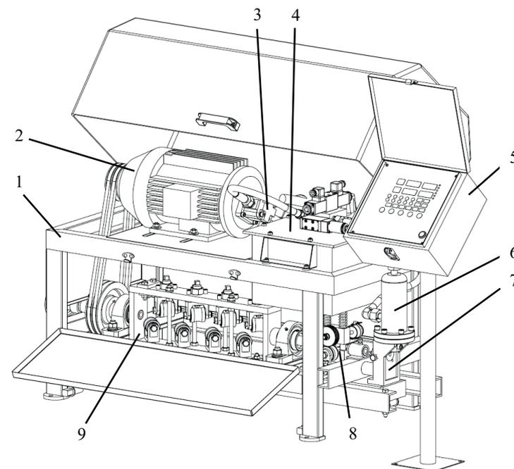
Рис. 1. Схема устройства правильно-отрезного станка VPK ПРО-12:
