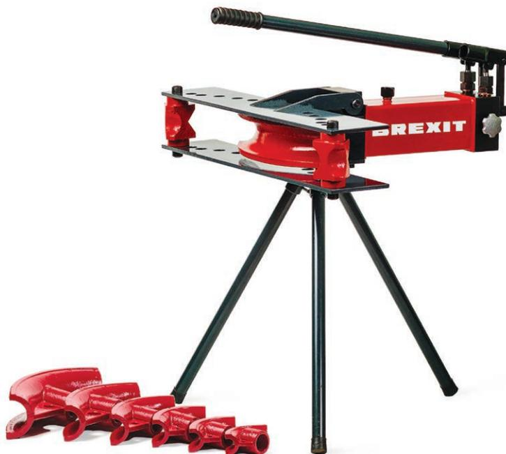
Предназначены для гидравлической гибки газовых, водопроводных и котельных труб диаметром от 1/2" до 4" (в зависимости от модели трубогиба) по ГОСТ 3262-75. Угол сгибания от 0 до 90 градусов.
