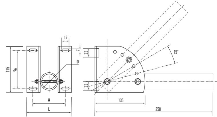
Рис.1 Держатель для уличных светильников PSL
