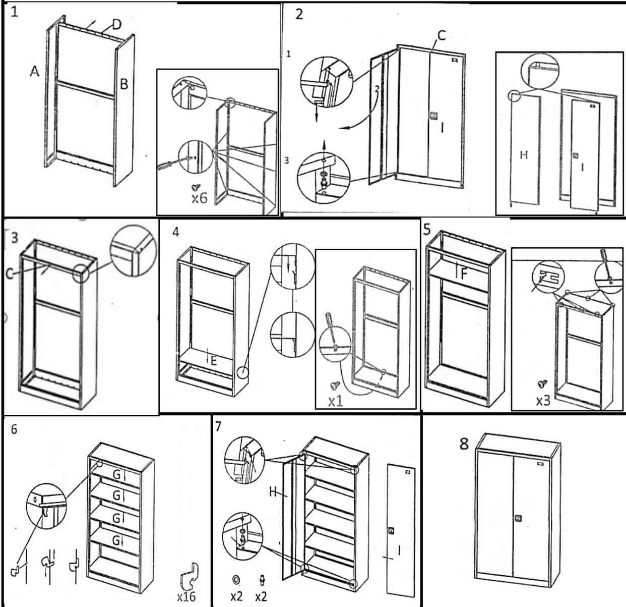
**Металлический архивный 2-дверный односекционный шкаф FC-A18**
