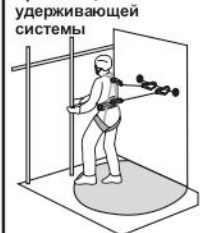
Рис. 15. Способ организации удерживающей системы
