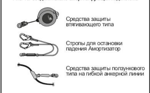
Рис. 15. Способ организации удерживающей системы
