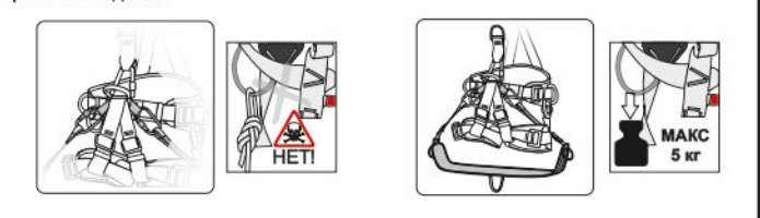
Рис. 18. Способ интеграции рабочего сидения
