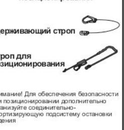
Внимание! Для обеспечения безопасности при позиционировании дополнительно организуйте соединительно-амортизирующую подсистему остановки падения.
