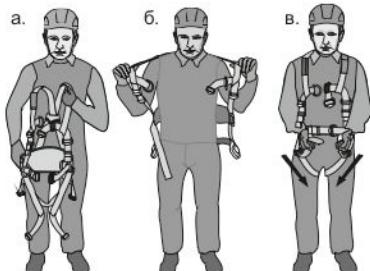
Рис. 6 Типы используемых пряжек, способы заправки
