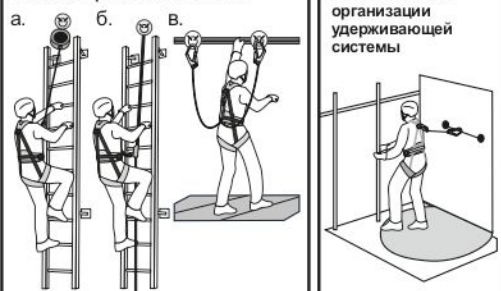
Рис. 13. Пример организации системы канатного доступа
