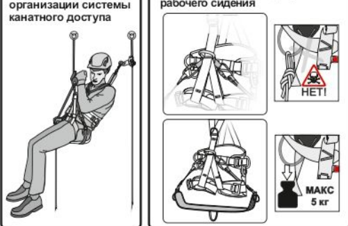
Рис. 13. Пример организации системы канатного доступа
