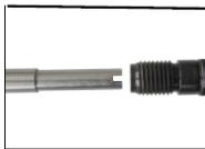
Вставьте центрирующий стержень так, чтобы захват рабочего шпинделя вошел в выемки на центрирующем стержне.
