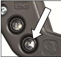
Кроме того, на рукоятке с переключателем находится индикатор, который заблаговременно предупреждает об отключении инструмента по причине износа угольных щеток. После того как загорится индикатор, инструмент сможет проработать еще ок. 1 дня. Потом угольные щетки должны быть заменены.
