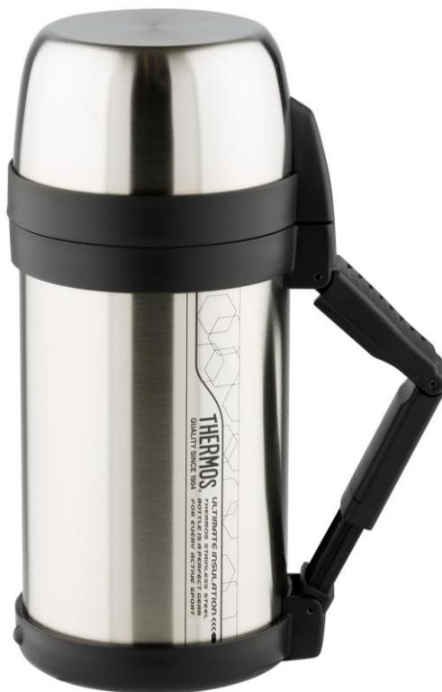
В соответствии с Международным стандартом качества EN12546-1:2000 температура жидкости через 6 часов для данного объема термоса должна быть не ниже 80°C. В результате тестирования температура через 6 часов составила **86°C** (на 8 % выше требуемой), Температура жидкости снизилась до 80°C через 9,5 часов.
