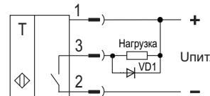
Примечание: состояние контакта (вывода) показано при отсутствии жидкости.
