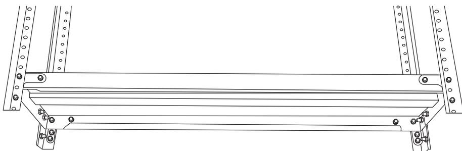
6. Зафиксируйте каркас стеллажа оставшимися стойками.
