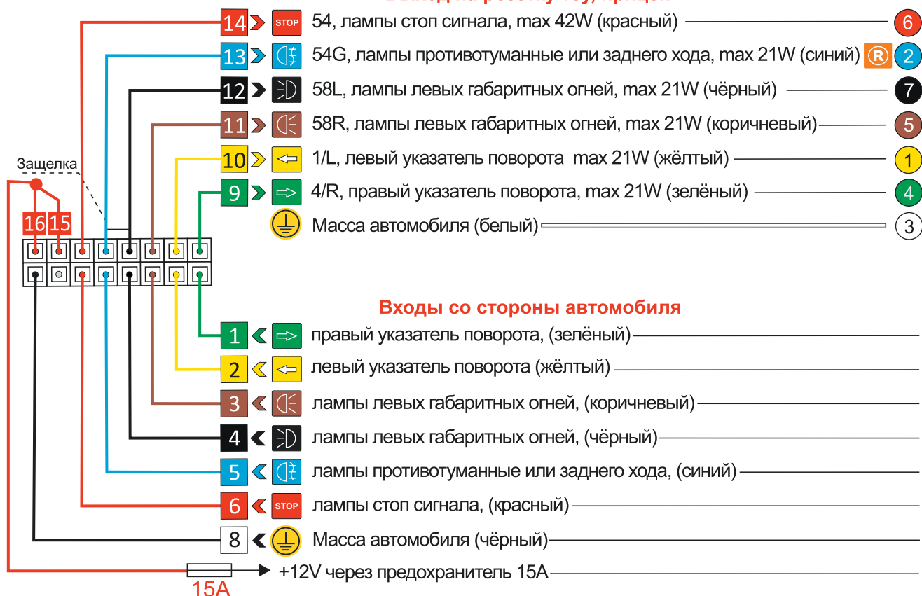
Розетка фаркопа со стороны подключения проводов, ISO1724
