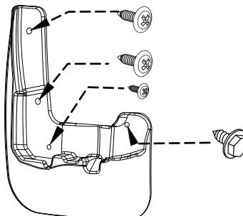
! Пружинную шайбу из комплекта поставки, закрепить с обратной стороны на саморез
