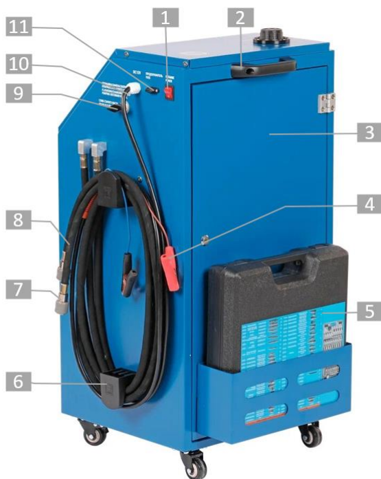
Рисунок 2 – Состав изделия (задняя и боковая сторона): 1) главный выключатель; 2) ручка для перемещения; 3) задняя дверца; 4) зажим для клеммы АКБ; 5) комплект переходников; 6) кронштейн для намотки шлангов; 7) быстрозажимная муфта; 8) шланг подключения к автомобилю; 9) переключатель слива старого масла; 10) кабель питания.
