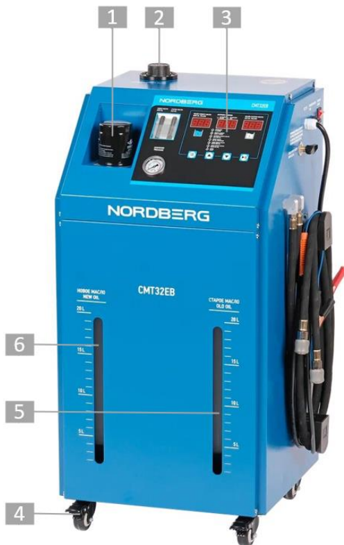
Рисунок 1 – Состав изделия (передняя сторона): 1) масляный фильтр; 2) заливная горловина; 3) панель управления; 4) поворотное колесо с тормозом; 5) указатель уровня масла в резервуаре для старого масла; 6) указатель уровня масла в резервуаре для нового масла.
