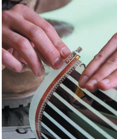
Рис. 10. Установленный на термопленку контактный зажим со стороны медной полосы (снизу)
