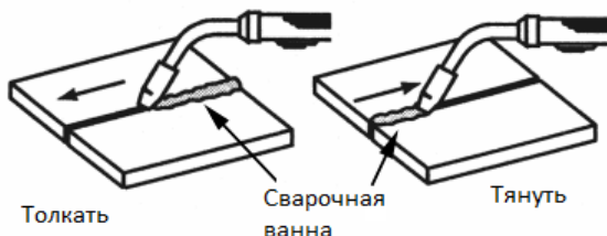
Рисунок 20. Направление движения горелки
