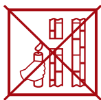
слабая тяга (Не используйте котел!)
