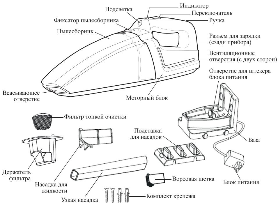
Ручной пылесос оборудован съемным **пылесборником с фильтром тонкой очистки в держателе**. Чтобы снять пылесборник, зажмите **фиксатор пылесборника** и осторожно потяните пылесборник в сторону от моторного блока.
