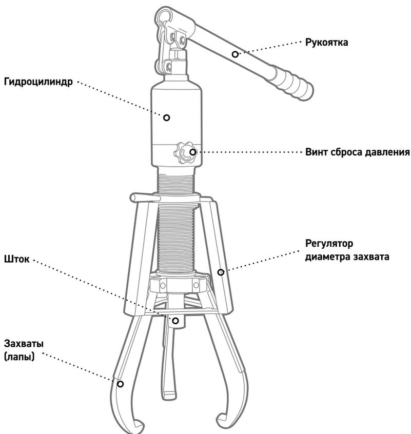
Съемник гидравлический автономный состоит из корпуса гидроцилиндра, встроенного плунжерного насоса, упорного штока, захватов (лап) и рукоятки. Встроенный насос, приводимый в действие за счет возвратно-поступательных движений рукоятки, нагнетает масло в рабочую полость гидроцилиндра, создавая давление на поршень.
