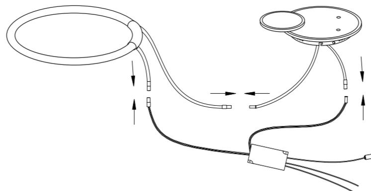
Схема подключения элементов плафона
