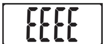
«**EEEE**» отображается, если весы перегружены. Снимите груз с весов, чтобы не повредить датчики.
