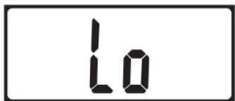
«**Lo**» отображается при низком заряде батареи. Весы выключатся через несколько секунд. Чтобы весы снова заработали, замените батарейки на новые.
