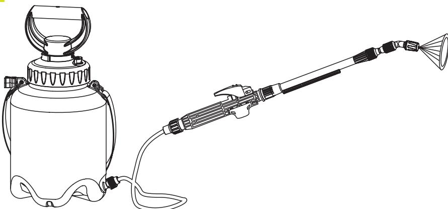
**XI** Промойте бак чистой водой. Затем промойте брандспойт, залив в бак чистую воду, накачав давление и распылив воду. Слейте остатки воды, сбросьте давление и нажав на клавишу ручки брандспойта, распылите остатки воды из брандспойта.
