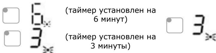
2. По истечении времени таймера приготовления соответствующая варочная зона автоматически выключится.
