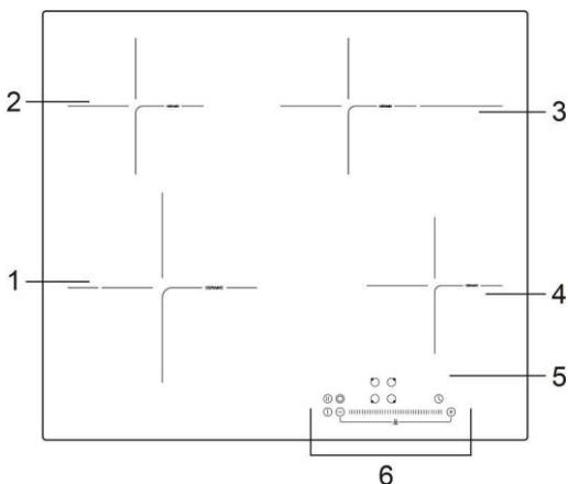
1. Электрическая конфорка макс. 2200/1000Вт на зону
