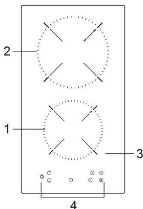
1. Электрическая конфорка макс. 1200Вт на зону
