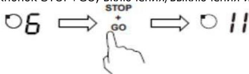
3. Для отмены данной функции, нажмите на кнопку STOP+GO, конфорка вернется на предыдущую мощность.
