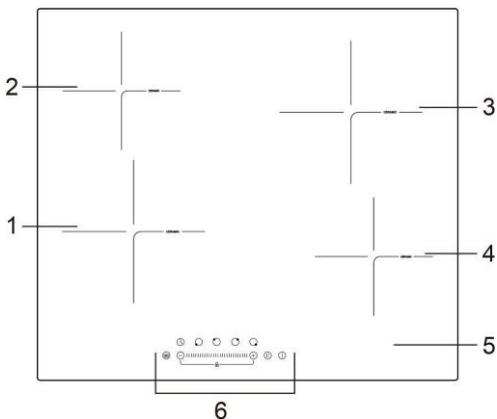
1. Электрическая конфорка макс. 1800Вт на зону
