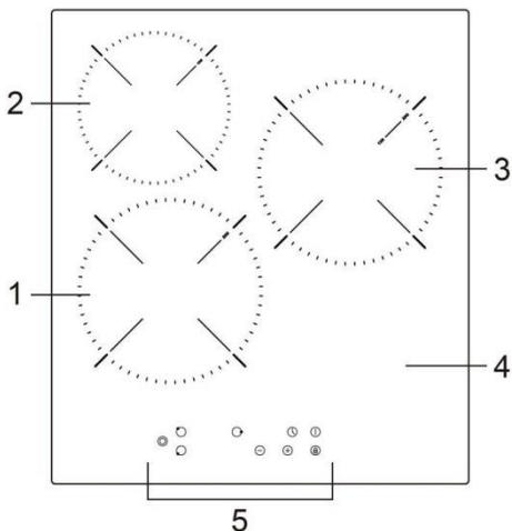
1. Электрическая конфорка макс. 1800Вт на зону
