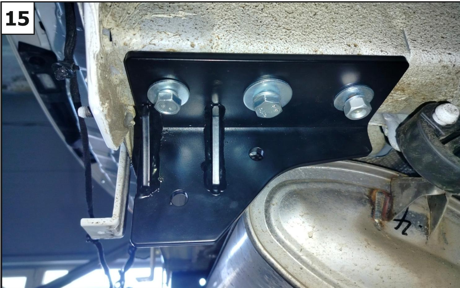
Установить кронштейн правый (3), закрепив к закладной с помощью болтов М10х1,25х35 (11), гайки М10х1,25 (15), шайб 10 увел. (19) и шайб 10 пружинных (20).
