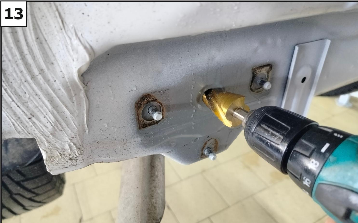
**Рассверлить отверстия в задней панели автомобиля до 30мм.**
