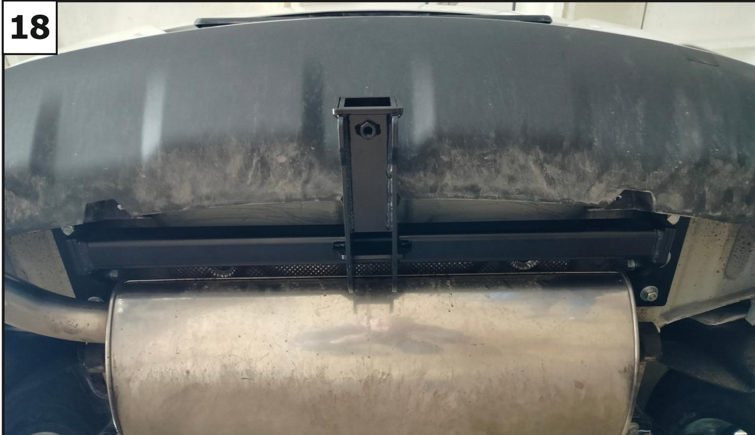
**Затянуть все резьбовые соединения - сначала балки к кронштейнам, после кронштейнов к лонжеронам. Моменты затяжки: M10=47 Нм, M12= 81 Нм. Установить усилитель на штатные гайки. После установить задний бампер в обратной последовательности**
