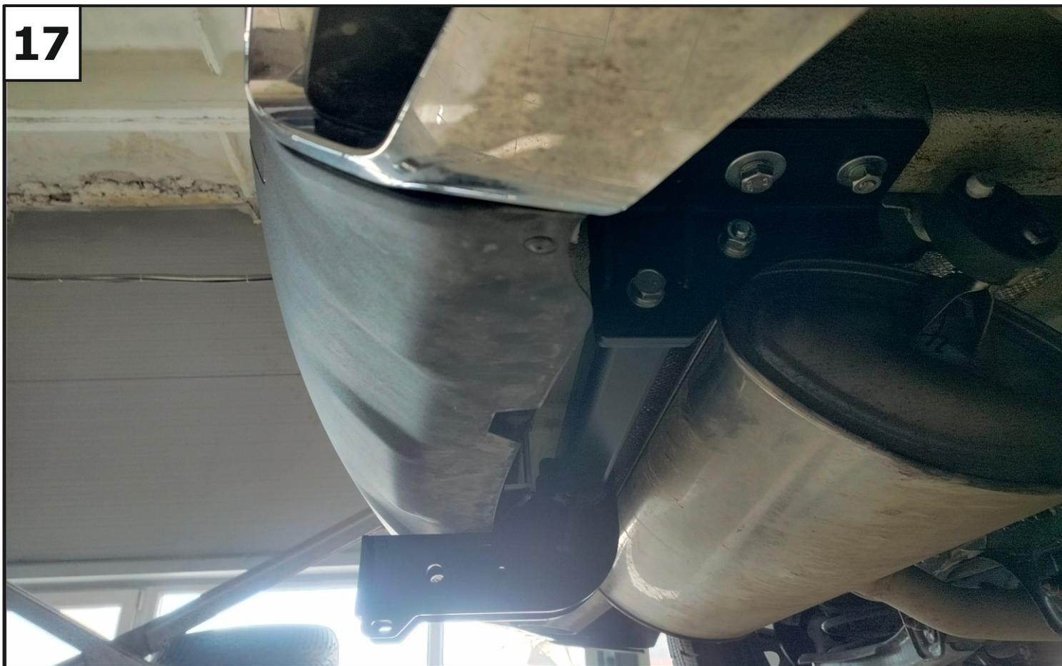
**К установленным кронштейнам закрепить балку (1) с помощью болтов М12х1,25х40 (10), гаек М12х1,25 (14), шайб 12 (17), шайб 12 пружинных (18).**
