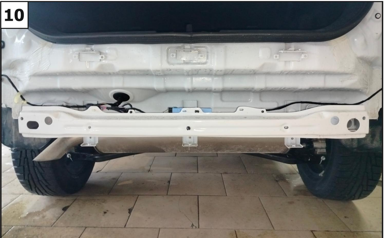
**Демонтировать проводку и антенну на усилителе бампера.**
