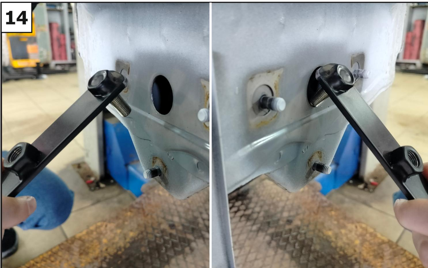
**Установить закладные в рассверленные отверстия в задней панели автомобиля и выставить в штатные отверстия лонжеронов.**
