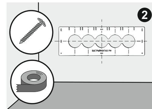
2. Установите шаблон используя центровочные метки. В зависимости от типа рабочей поверхности используйте саморез с пресс-шайбой или двусторонний скотч. Для крепления саморезами рекомендуется использовать крайние центральные отверстия по горизонтали.
