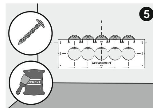
5. Нанесите фиксирующий раствор на тыльную часть подрозетников и вставьте в подготовленные отверстия. При необходимости закрепите шаблон саморезами.
