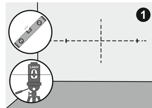
1. Используйте уровень или лазерный нивелир для предварительной разметки места установки.
