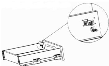
Регулировка фасада верх-низ  $\pm 1,5$  мм
