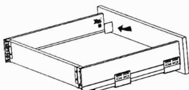
Открепите фасад с помощью отвёртки
