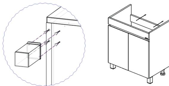
6) При монтаже тумбы под раковину необходимо следить чтобы верхняя плоскость тумбы была строго горизонтальна. Регулировка осуществляется специальной фурнитурой, предусмотренной для каждого типа модуля (напольные тумбы: мебельные опоры-ножки; навесные тумбы: регулируемые мебельные навесы).
