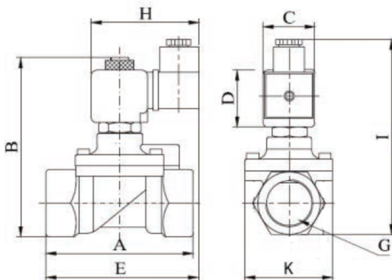
Рис. 5.2 Габаритные и присоединительные размеры клапана типа EV250R
