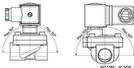
Клапаны типа EV250R рекомендуется устанавливать катушкой вверх, что снижает риск накопления загрязнений в трубке якоря. Если используется «чистая» среда, не содержащая частиц грязи, то клапан типа EV250R будет надежно работать и при монтаже с различной ориентацией, как это показано на рисунке 5.1.1.
