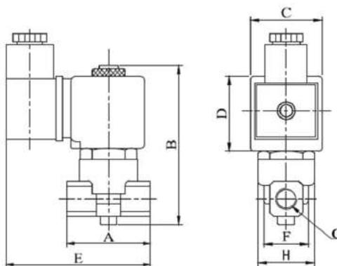
Габаритные размеры нормально закрытых клапанов:
