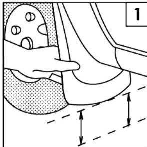
Приложите брызговик по форме крыла автомобиля, держа его нижнюю часть параллельно земле.
