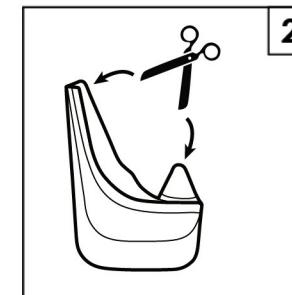
В случае неплотного прилегания брызговика к кузову автомобиля, подрежьте выступающие края ножницами.
