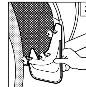
Придерживая брызговик в местах прилегания к 3-м просверленным отверстиям в крыле автомобиля, прикрутите его саморезами в порядке от высшей точки крепления к низшей.
