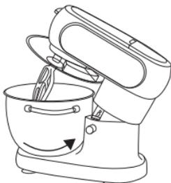
3. Извлеките использованную насадку (венчик для взбивания, крюк для замешивания теста, насадку для смешивания). Для этого слегка надавите на насадку вверх, поверните ее по часовой стрелке и снимите с оси.
