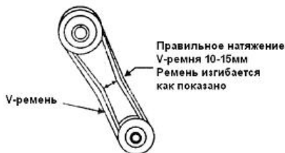
рис. 18 Натяжение V-ремня
