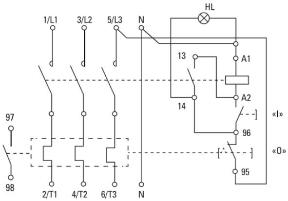
Рис. 4 - Схема подключения пускателя 40-95 А 230 В
