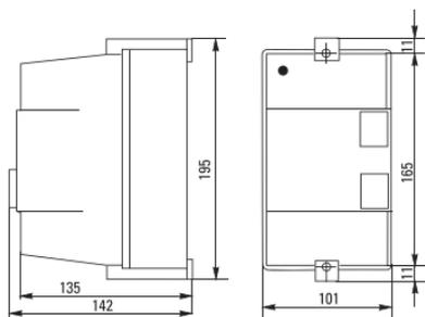
Рис. 6 - Габаритные размеры для КМЭ 25-32А
