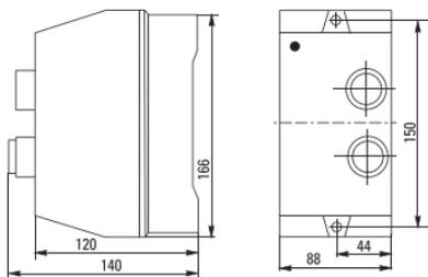
Рис. 5 - Габаритные размеры для КМЭ 9-18А
