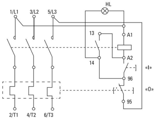
Рис. 1 - Схема подключения пускателя 9-32 А 400 В
