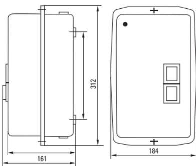
Рис. 7 - Габаритные размеры для КМЭ 40-95А
