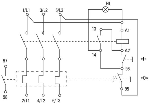
Рис. 2 - Схема подключения пускателя 40-95 А 400 В
