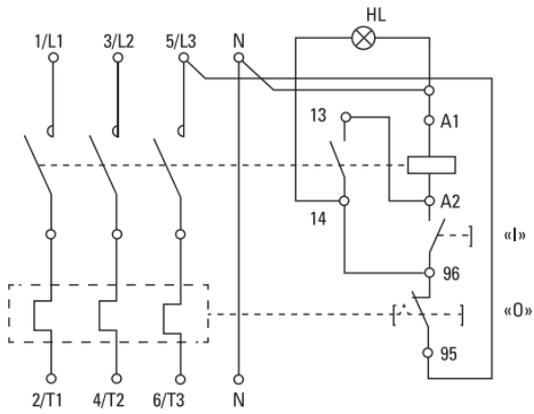
Рис. 3 - Схема подключения пускателя 9-32 А 230 В
