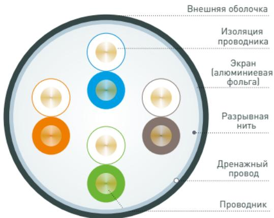
Рис. 2 – Конструкция кабеля F/UTP(количество жил 4x2)
