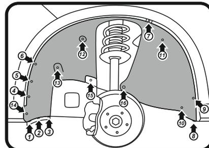
Передний левый. Монтаж крепления. Рис. 2
