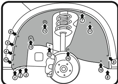
Передний левый. Монтаж крепления. Рис. 2
