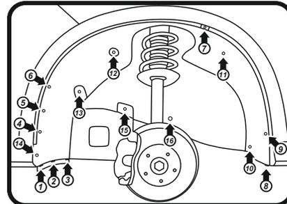
Передний левый. Демонтаж крепления. Рис. 1
