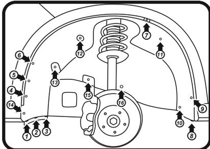
Передний левый. Демонтаж крепления. Рис. 1
