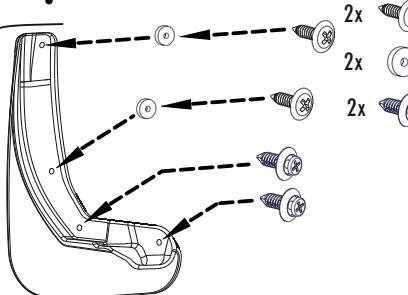
Саморез  $4,2 \times 16\text{мм}$
