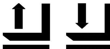
Кнопка подъема и кнопка опускания расположены на обеих боковых поверхностях средней рукоятки управления. Нажмите кнопку подъема, вилы поднимутся; нажмите кнопку опускания, вилы опустятся.
