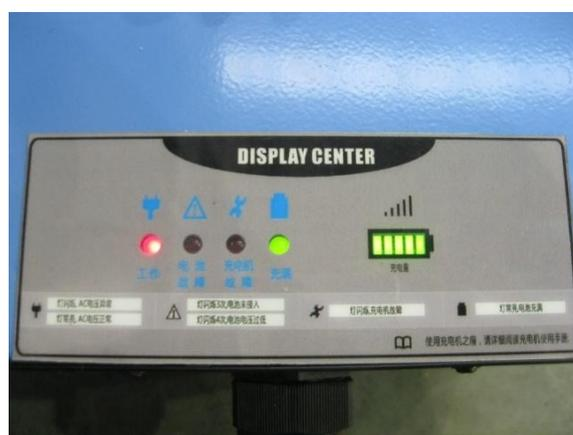
Выньте вилку зарядного устройства из розетки после завершения зарядки выключите питание зарядного устройства и выньте вилку зарядного устройства из розетки.
