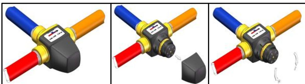
5.3. Температура воды на выходе термостатического смесительного клапана устанавливается с помощью регулировочной рукоятки (см. рис. выше) в соответствии с таблицей ниже.
