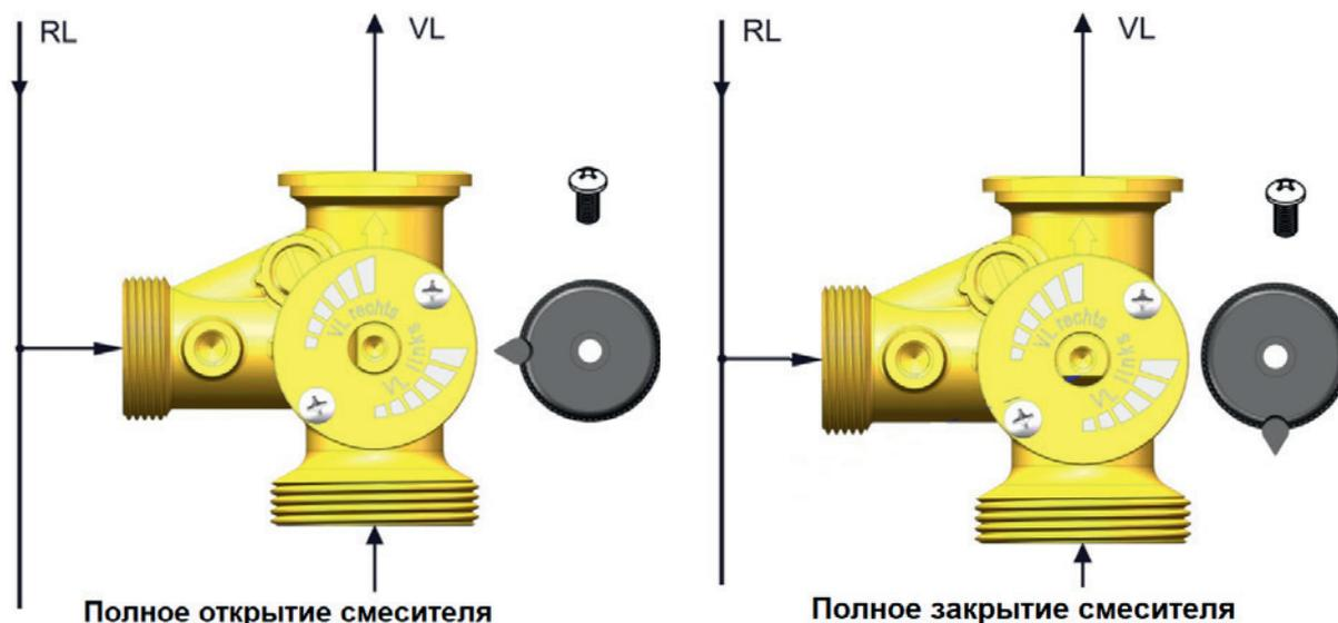
В трёхходовой смесительный клапан встроен байпас, который при поставке оборудования находится в закрытом положении. Возможно ступенчатое регулирование этого байпаса. Для этого необходимо снять круглую пластину со шкалой, выкрутив два винта и затем повернуть регулятор байпаса, открыв канал байпаса на величину от откp. до закp. (см. рис. ниже):
