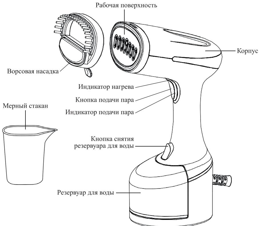
Отпариватель оснащен помпой (водяным насосом). Вода из резервуара подается помпой в бойлер, где испаряется. Пар выходит через отверстия на рабочей поверхности. Использование помпы позволяет точно дозировать количество подаваемой в бойлер воды и получать устойчивую подачу пара.
