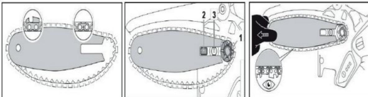
1. Установите шину на несущий болт. Расположите шину максимально близко к ведущей звезде и наденьте цепь на ведущую звезду.
