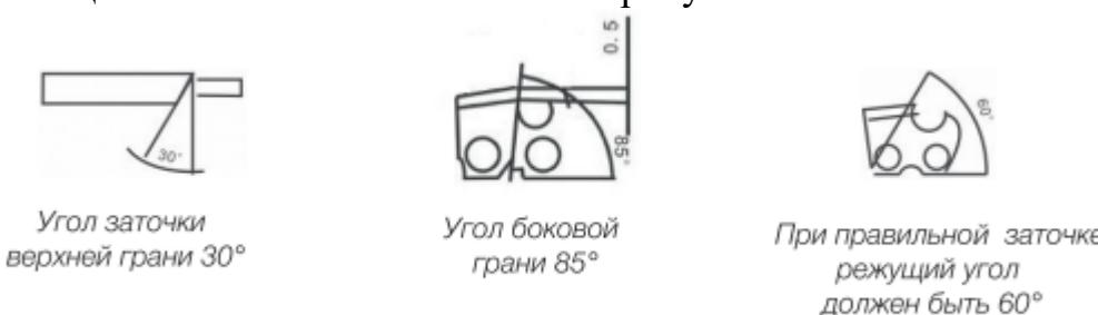
Затачивание делают «от себя», параллельно отметке — риске, которая есть на всех зубьях. Косая риска — это указатель угла заточки. Усилия и число движений должны быть равномерными на каждом зубце.
