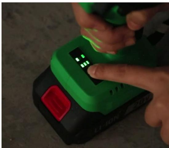
Затем нажмите на кнопку блокировки, а затем на пусковой включатель и удерживайте его нажатым. Пока инструмент включен, кнопку блокировки можно отпустить. Чтобы выключить инструмент, отпустите пусковой переключатель, а затем выключите панель (9).
