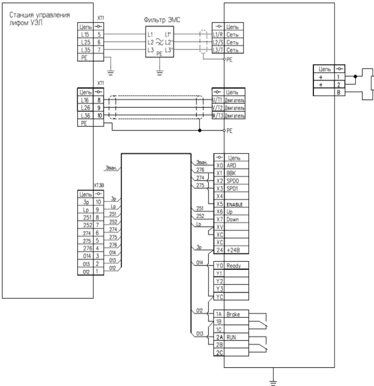
Рис. 36 Подключение ПЧ AS 620/AS320 к станции УЭЛ
