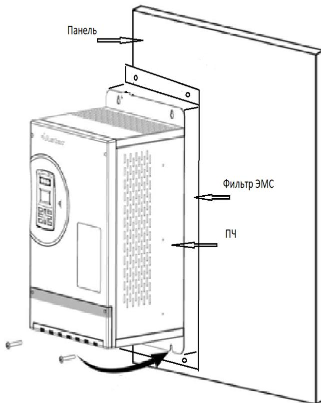
Рис1а. Установка ПЧ с минимальными размерами
