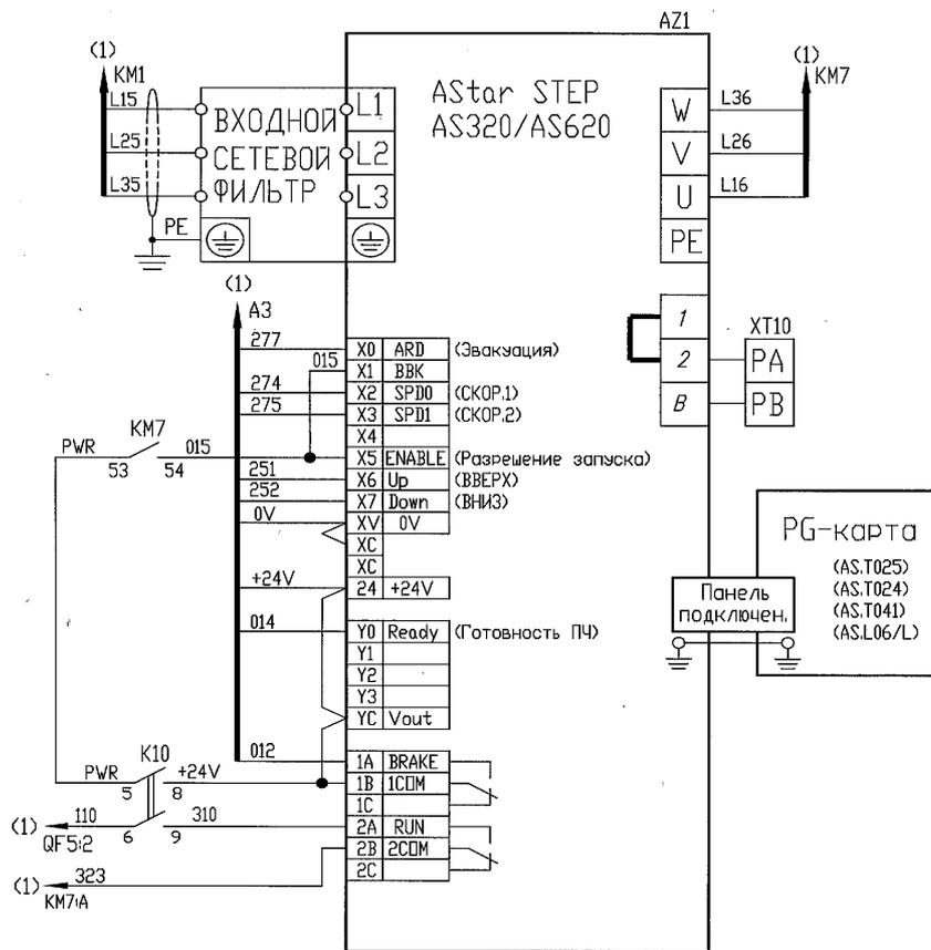
Рис. 3в Подключение ПЧ AS 620/AS320 к станции УЛ со встроенным ПЧ в шкафу
