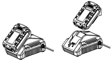
1. Заряжайте литий-ионный аккумуляторный блок только с помощью подходящего зарядного устройства.
