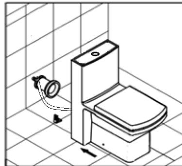
6. Прикрепите унитаз с помощью винтов к кронштейнам, закройте головки винтов декоративными колпачками (рис.7).
