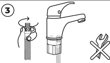
3 Вкрутите гибкую подводку (концевую арматуру затягивайте с усилием не более 0,4 Нм без использования инструментов)
