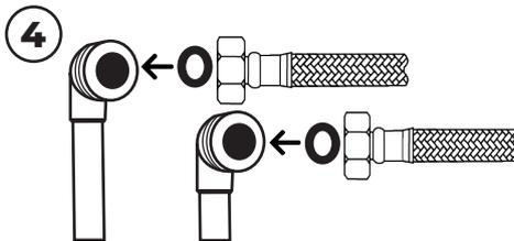
4 Подсоедините гибкую подводку к системе водоснабжения с использованием уплотнителей согласно ГОСТ Р70407-2022
