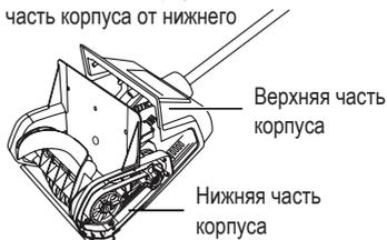
4. Снимите четыре винта и две гайки с кронштейна двигателя
