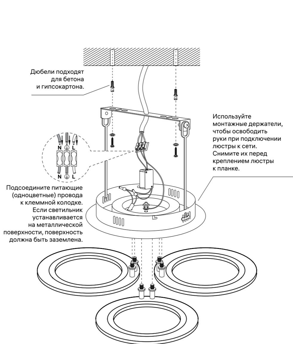
Подсоедините питающие (одноцветные) провода к клеммной колодке. Если светильник устанавливается на металлической поверхности, поверхность должна быть заземлена.
