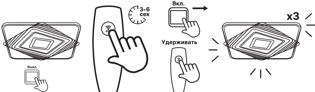
1. Выключите люстру с помощью настенного выключателя 2. Нажмите кнопку на пульте и удерживайте 3-6 сек. 3. Удерживая, включите люстру с помощью настенного выключателя, повторно коротко нажмите кнопку, люстра моргнет 3 раза или поменяет цвет свечения.
