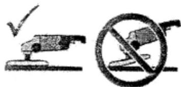
**Рис.А. Угол наклона при полировке**
